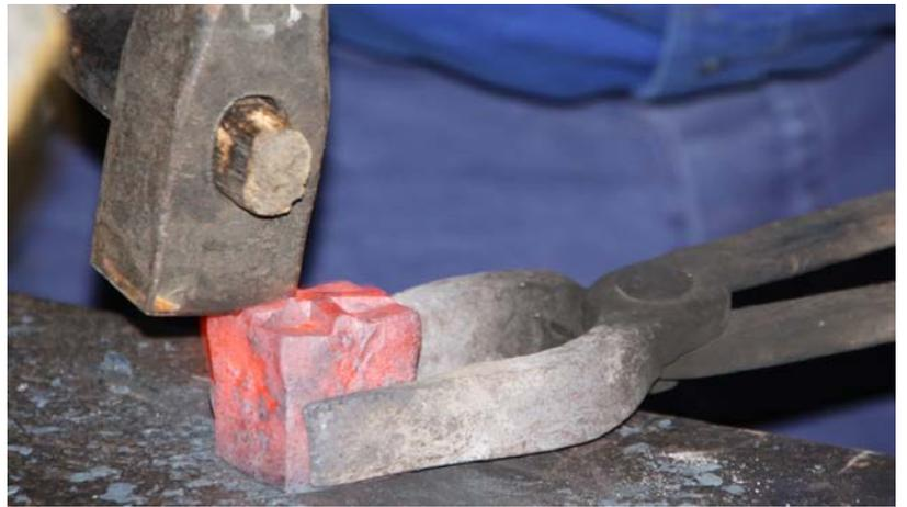
Auf dem **Amboss** gibt unser Schmied - unter Assistenz eines "Zuschlägers" - dem Rohling durch "**Freiformschmieden**" die gewünschte Form: Auf der Kopfseite ein (erhabenes) Kreuz, auf der Unterseite werden die Buchstaben **MK** eingeschlagen. Sie stehen für "Missionshaus Knechtsteden".
